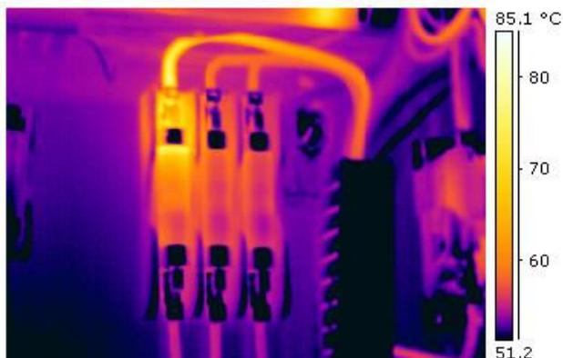
A **ALA Infraestrutura** disponibiliza a seus clientes análises termográficas por meio de imagens, utilizando equipamentos de alta tecnologia e elevado desempenho, que permitem a detecção de possíveis avarias ou não conformidades em equipamentos elétricos, eletrônicos, mecânicos e de processos, entre outros.
